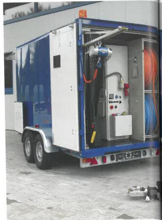
Streicher-Sanierungssystem mit Einlaufsanierungsroboter EL300...
